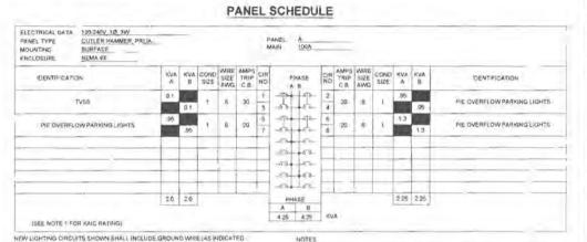
NEW LIGHTING CIRCUITS SHOWN SHALL INCLUDE GROUND WIRE (AS INDICATED ON IT UNI) GROUND WIRE TO HAVE GREEN, TYPE THVM INSULATION
